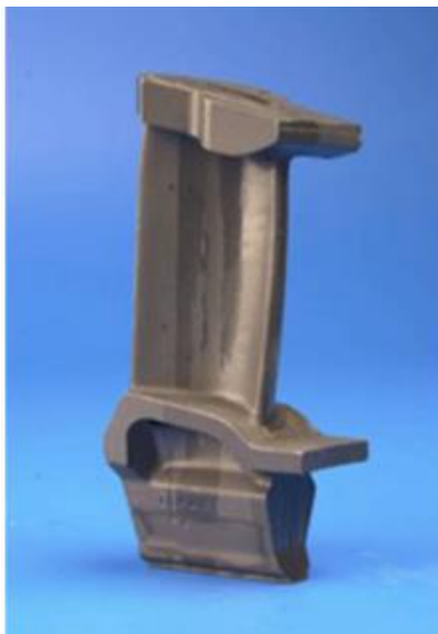
图 1 Ni 基高温合金定向柱状晶叶片
